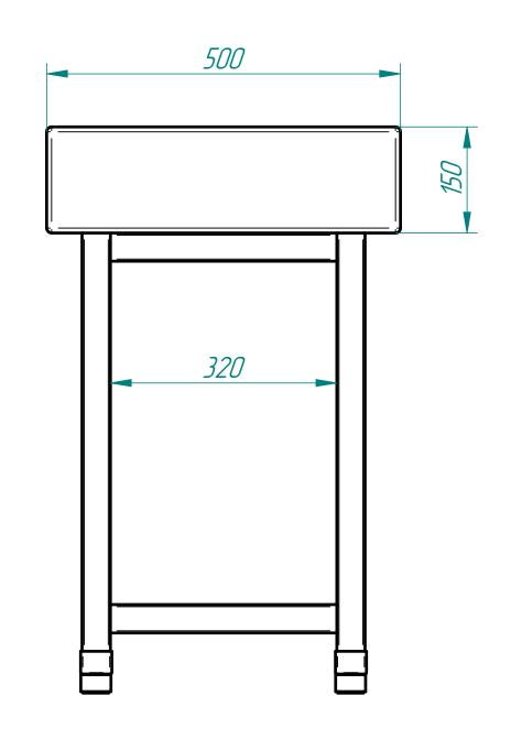
Колода для рубки мяса, предназначена для исполь зования на предприятиях общественного питания, в качестве вспомогательного оборудования, для выполнения работ, связанных с разделкой мяса. Столешница выполнена из древесины (бук склееный). Сварной каркас выдерживает большие нагрузки. Колода имеет регулируемые по высоте ножки.
