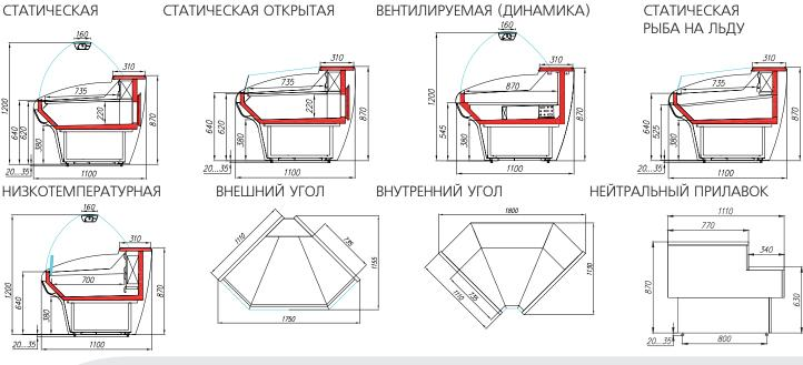
Климатический класс оборудования: 3 Предназначены для эксплуатации в закрытом помещении с естественной вентиляцией при температуре окружающего воздуха +12до +25 и относительной влажности не более 60%.
