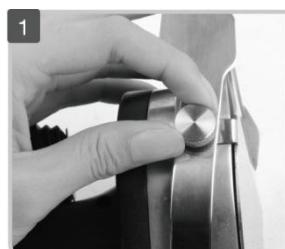
**Снимите стопорный винт и регулировочное кольцо.**
