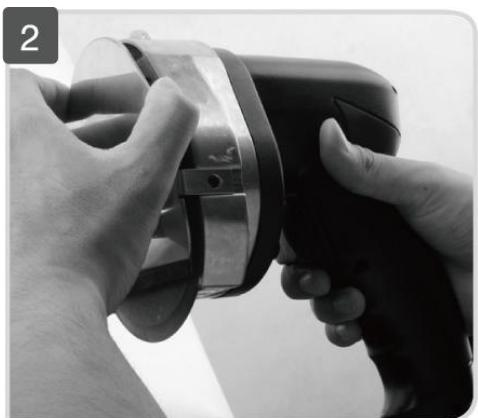
**Снимите защитный кожух ножа.**
