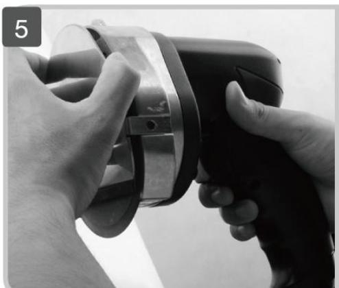
Установите защитный кожух ножа и стопорный винт.
