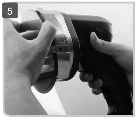
**8.** Установите защитный кожух ножа и стопорный винт.
