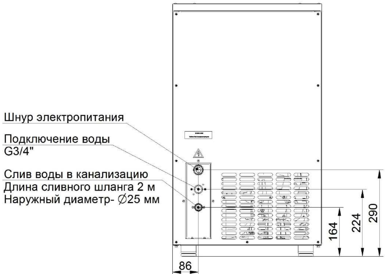
Рис. 4 Схема подключения льдогенератора
