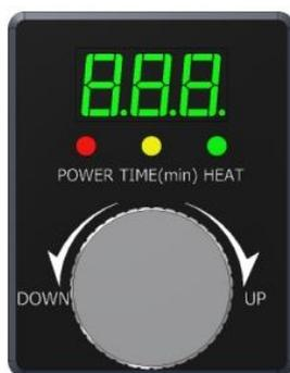
Панель управления имеет индикатор включения питания «POWER». Индикатор таймера «TIME(min)», индикатор включения нагрева «HEAT». Панель имеет круглую ручку с помощью которой можно : включать/выключать плиту, устанавливать степень нагрева, выставлять таймер. На панели имеется индикатор, отображающий текущие режимы работы плиты (степень нагрева и время таймера в минутах).
