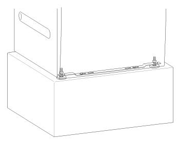
С помощью прилагаемых крепящих уголков передние ножки прибора можно закрепить прямо к полу. Крепеж рассчитан на дюбельное крепление к бетонному полу.
