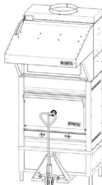
Рисунок 5 – Перемещение печи – мангала на подставке
