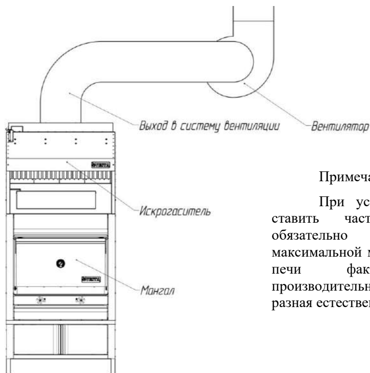
Рисунок 7 – Схема подключения мангала к вентиляции
