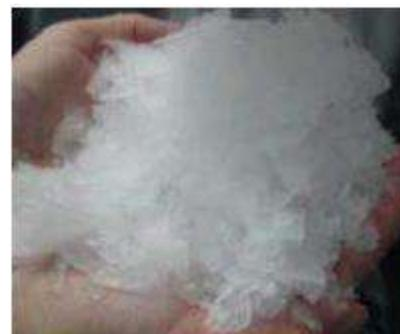
Фото чешуйчатого льда при использовании смеси соленой и пресной воды
