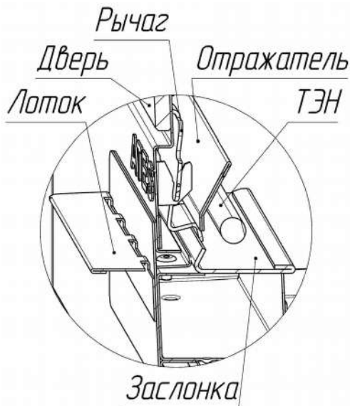
Рис. 4 Установка рычага и заслонки
