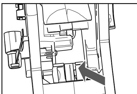
**3** Установите заново блок приготовления кофе в специальное отделение до достижения соединения BE3 нажатия на кнопку «PUSH».
