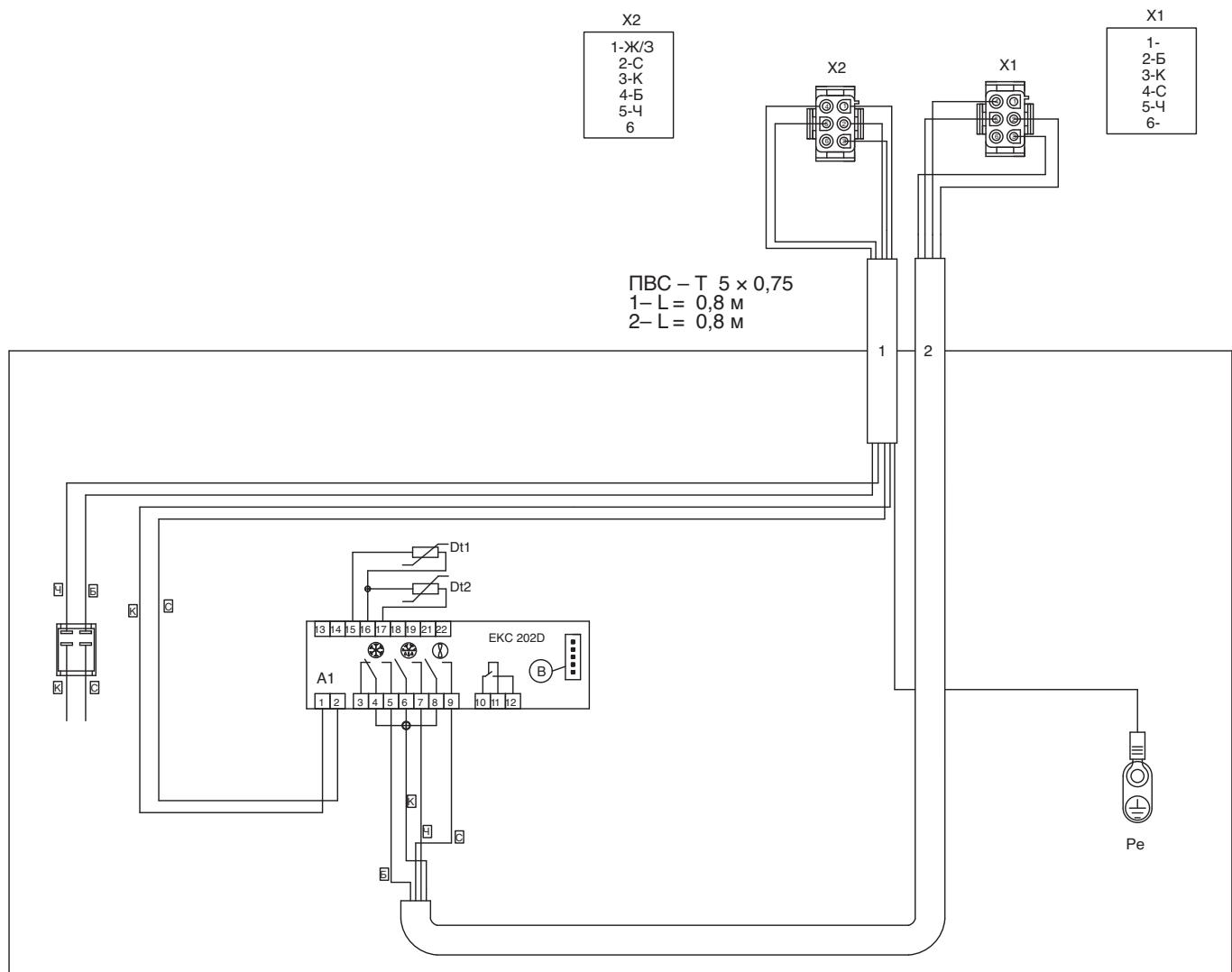
Схема электрическая монтажная холодильной витрины
