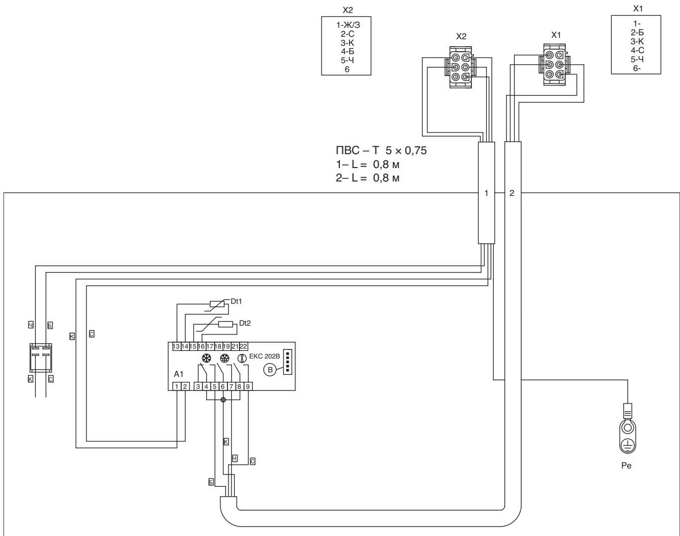
Схема электрическая монтажная холодильной витрины
