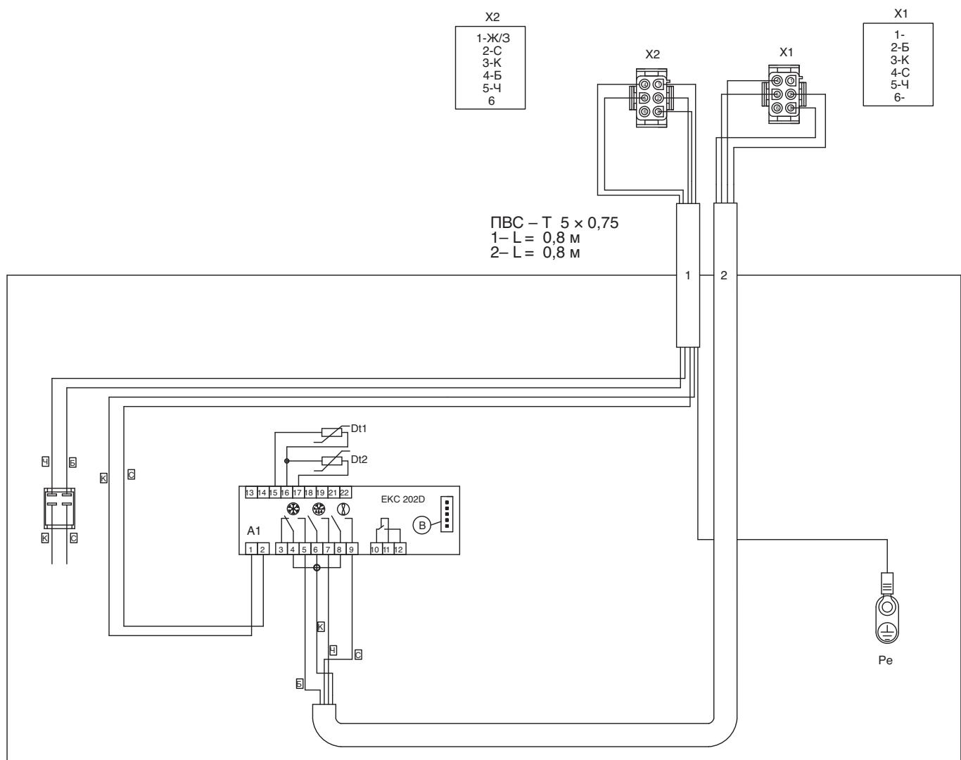
Схема электрическая монтажная холодильной витрины
