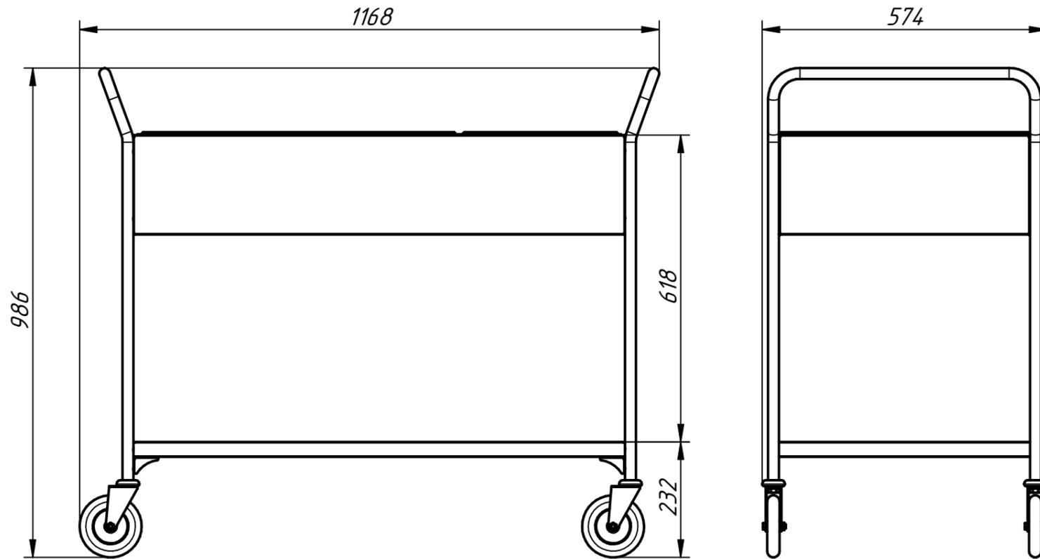
Тележка для сбора посуды является вспомогательным оборудованием на предприятиях общественного питания и используется для транспортировки использованной посуды и столовых приборов. В качестве емкостей используются одна гостроемкость GN2/1, глубиной 200мм, и одна гостроемкость GN1/1, глубиной 150 мм. Тележка имеет четыре поворотных колеса большого диаметра, два из которых имеют стопор. Все детали тележки изготовлены из нержавеющей стали.
