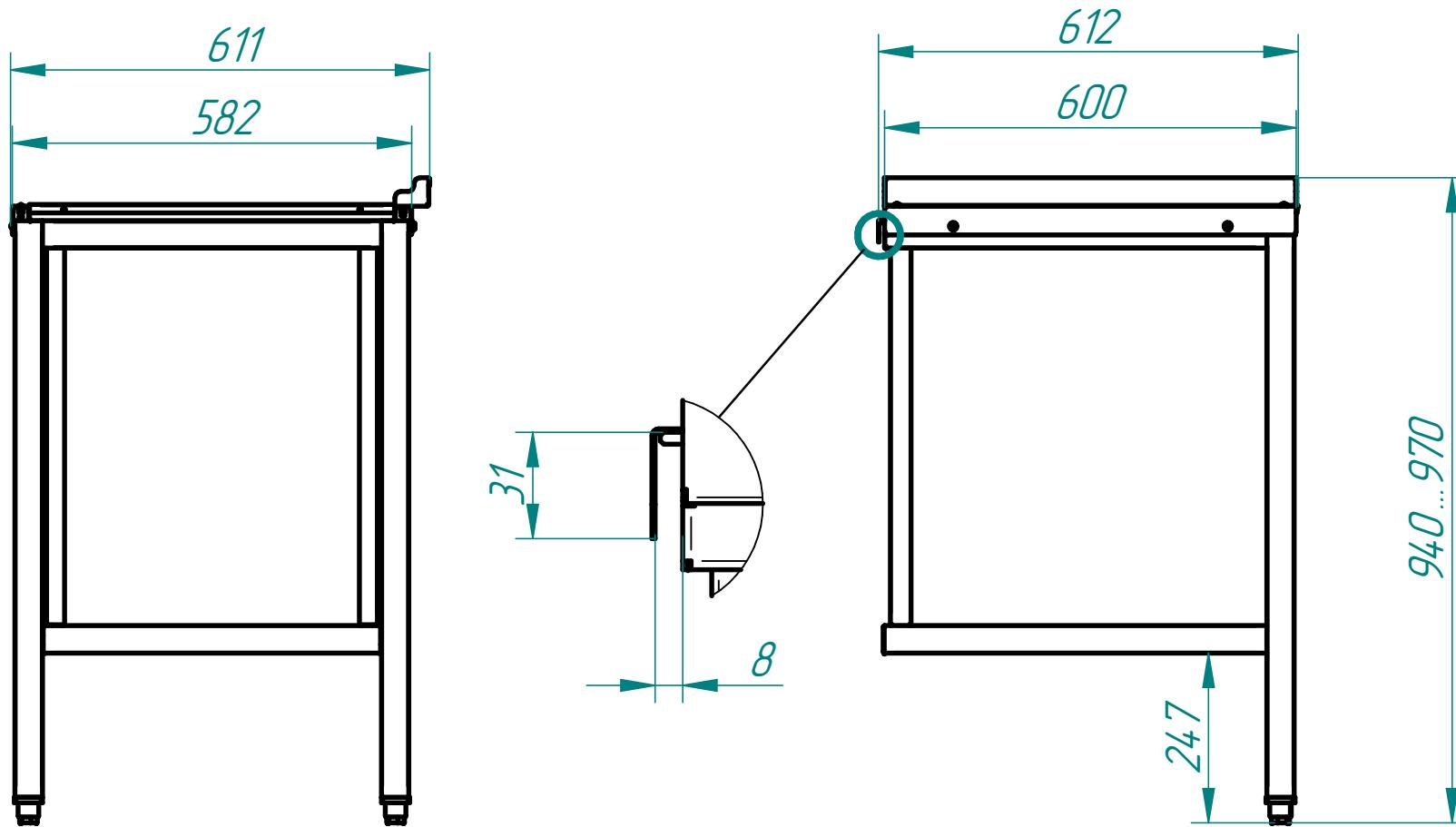
Стол раздаточный используется в комплексе с купольной посудомоечной машиной, имеет регулируемые по высоте ножки (не менее 20 мм). Крепление к посудомоечной машине осуществляется с помощью верхнего зацепа и нижних винтов. Путем несложного монтажа стол можно установить как в левом, так и правом исполнении.
