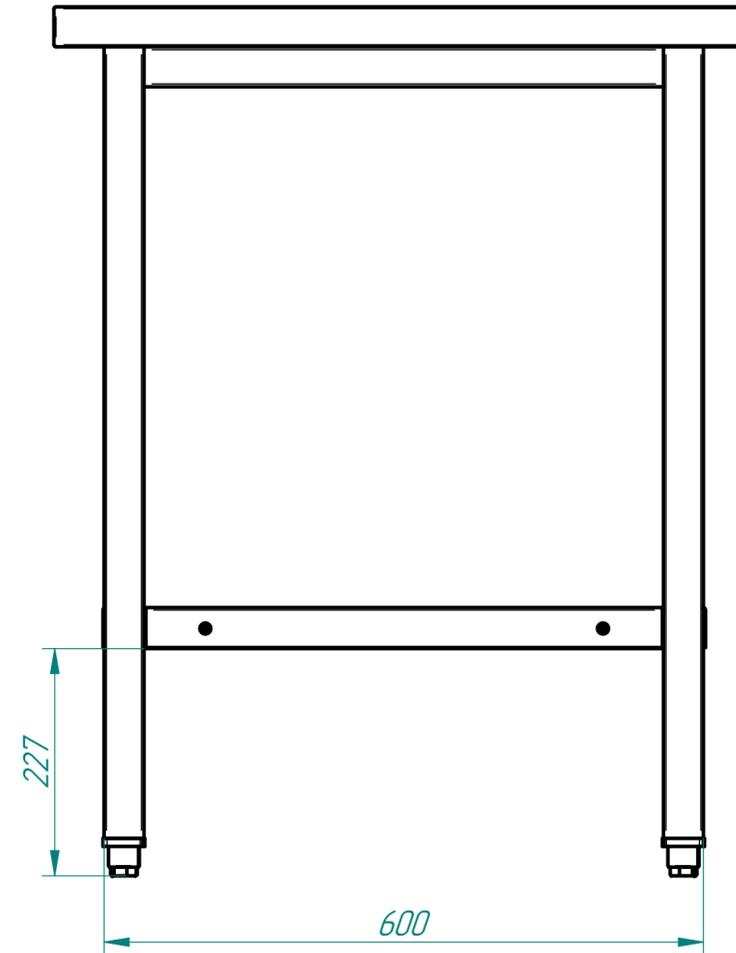
Стол кондитерский разборный СКР предназначен для использования на предприятиях общественного питания и предприятиях торговли в качестве вспомогательного оборудования. Используется на предприятиях общественного питания самостоятельно или в составе технологических линий. Все детали стола изготовлены из высококачественной нержавеющей стали. Стол имеет столешницу из бука и регулируемые по высоте ножки.
