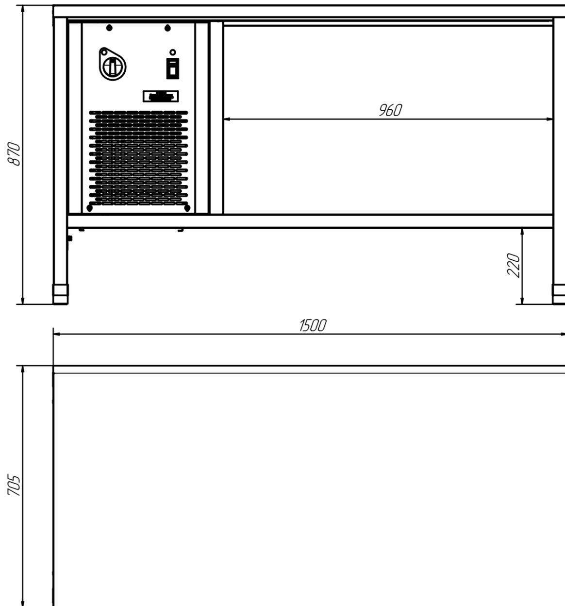
Стол охлаждаемый ПВВ(Н)-70-СО предназначен для разделки полуфабрикатов мяса и рыбы, может так же использоваться на мясных и рыбных рынках для демонстрации и выкладки продуктов. Рабочая поверхность стола - охлаждаемая ровная поверхность. Внизу расположена открытая полка для кухонного инвентаря. Стол имеет регулируемые по высоте ножки.
