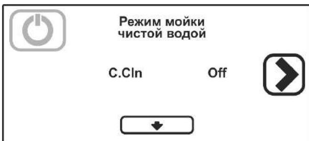
Предусматривает использование чистой воды в **каждом цикле мойки**. При выполнении каждого цикла моечная вода полностью сливается и заменяется чистой водой, поступающей из ополаскивания.
