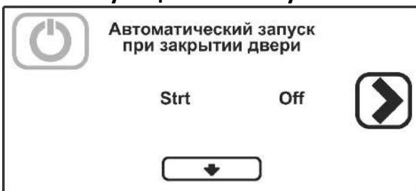
Если она настроена на "вкл.", то цикл запускается при закрытии дверцы/капота. При настройке на "выкл" цикл начинается после подтверждения.
