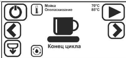
Когда на дисплее отобразится "Конец цикла", то после открытия дверцы/капота посудомоечная машина будет готова к следующему циклу мойки.
