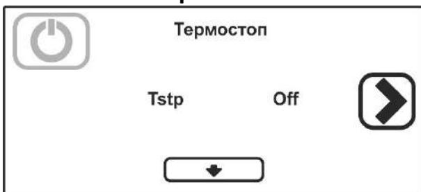
При настройке на “вкл.” = **минимальная температура ополаскивания** соответствует настроенной (см. температуру бойлера выше), вне зависимости от температуры поступающей воды; номинальная продолжительность цикла может увеличиваться на несколько секунд.
