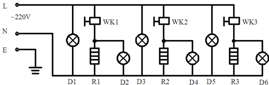
WK1, WK2, WK3—регулятор температуры D1, D3, D5—индикатор питания D2, D4, D6—индикатор нагрева R1, R2, R3—нагревательный элемент
