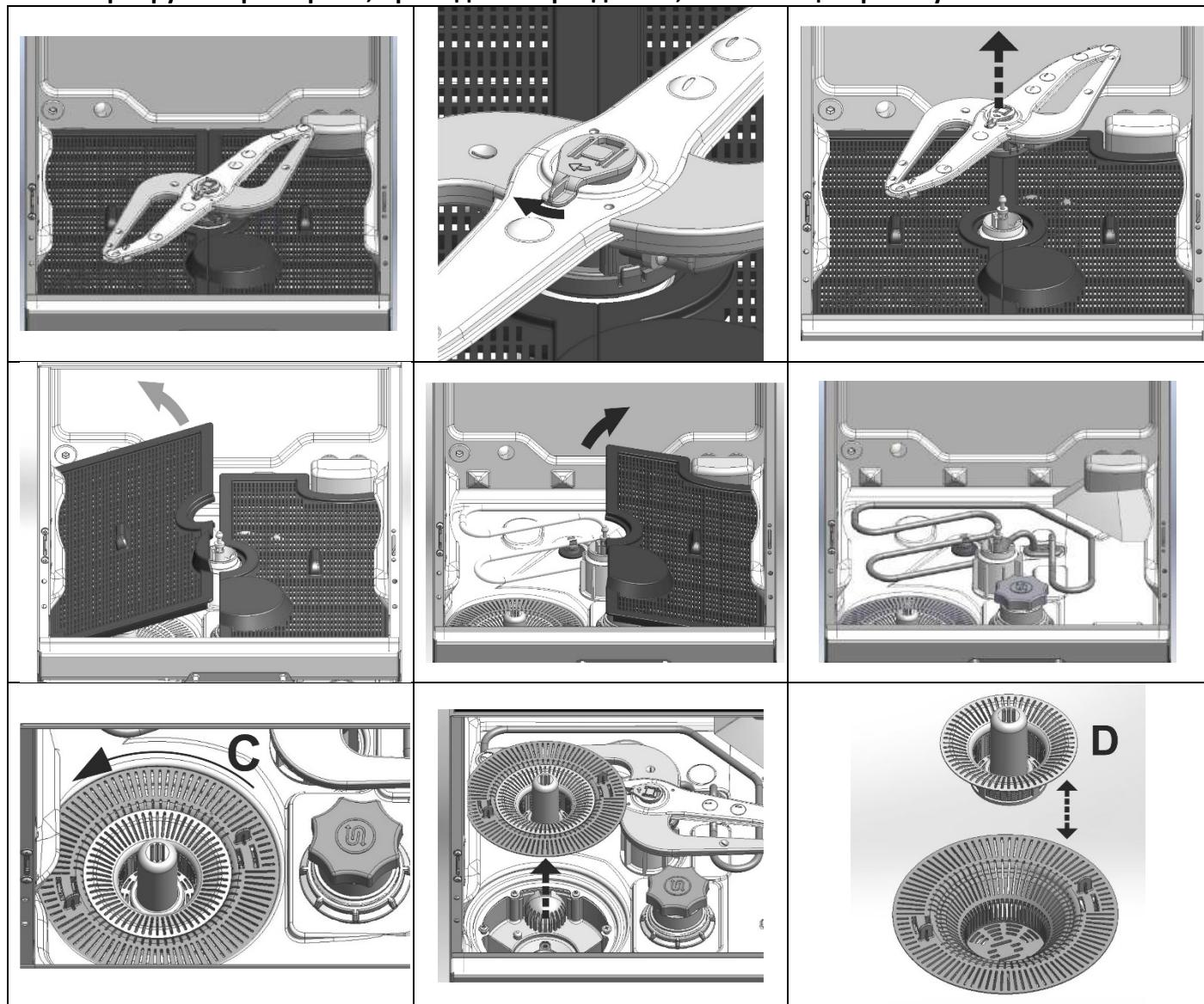
Процедура демонитрования фильтров с двумя фильтрующими элементами:
