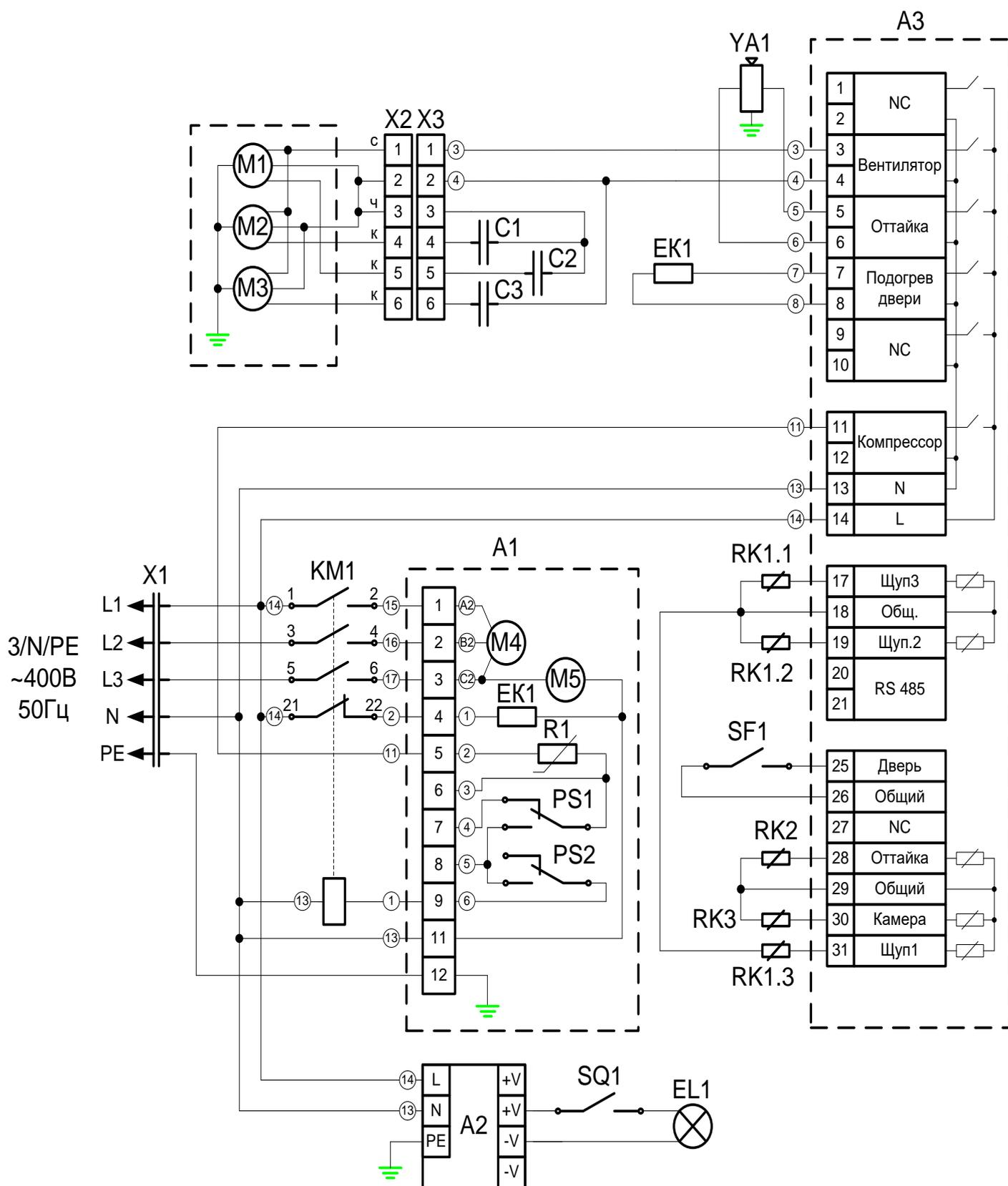
Рис.9 Принципиальная электрическая схема шкафа
