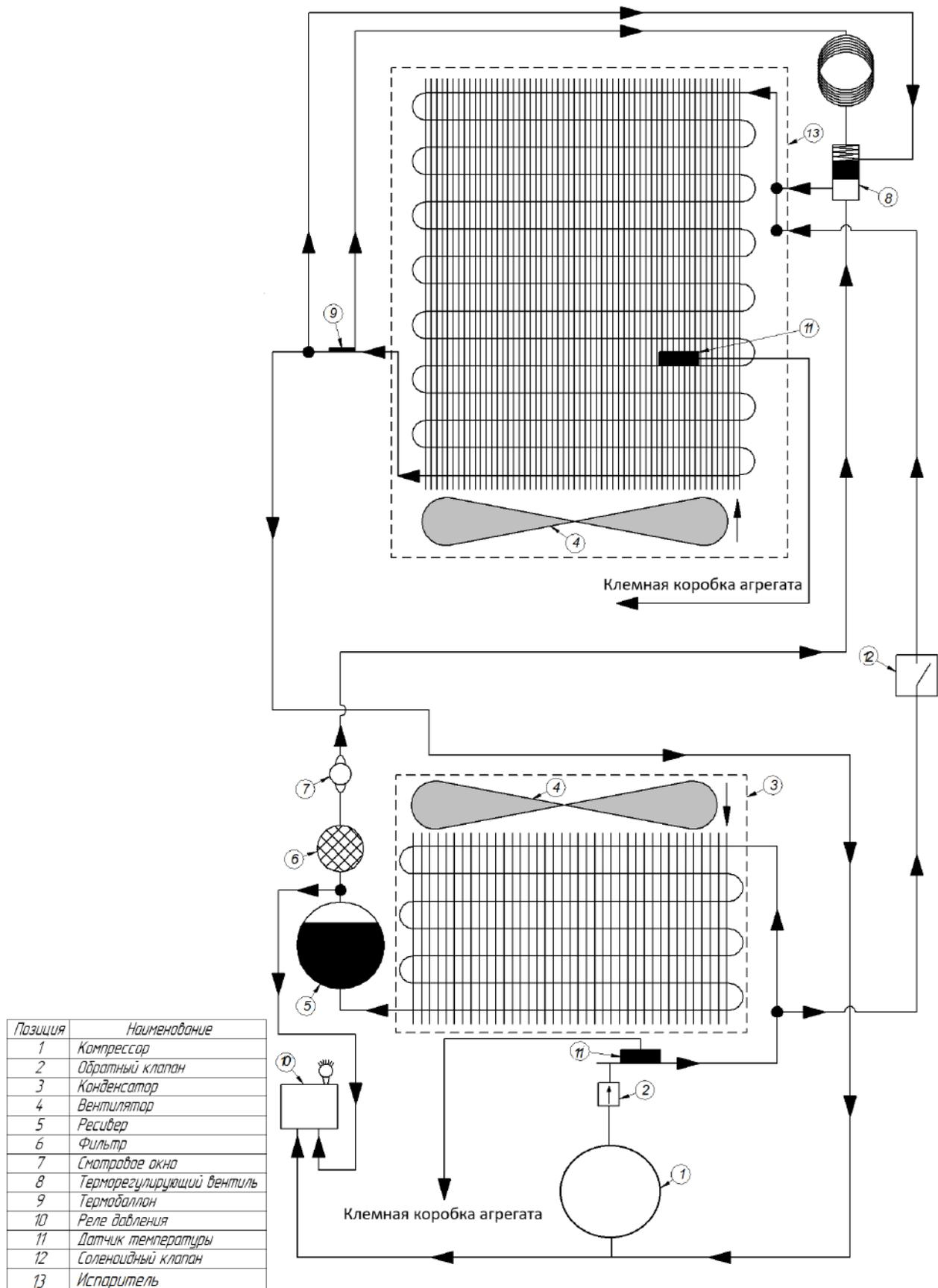
Рис.2 Принципиальная схема системы охлаждения
