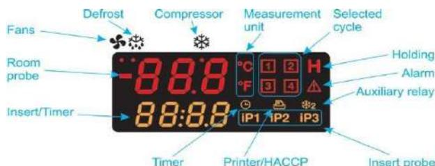
Рис.6 Дисплей контроллера
