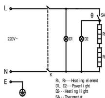
Heating element – нагревательный элемент
