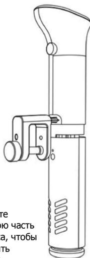
Снимите нижнюю часть корпуса, чтобы очистить внутри.
