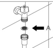
Гидравлические трубы и кабель электро питания выведены в задней нижней части справа. Подключить трубу гидро питания к гнезду с разъемом с резьбой  $\frac{3}{4}$ " gas, вставляя фильтр **A** в оборудование (в моделях с аквастопом фильтр и зажимное кольцо образуют единую деталь). Для подключения к водопроводу используйте только новые трубы; нельзя использовать старые или б.у трубы
