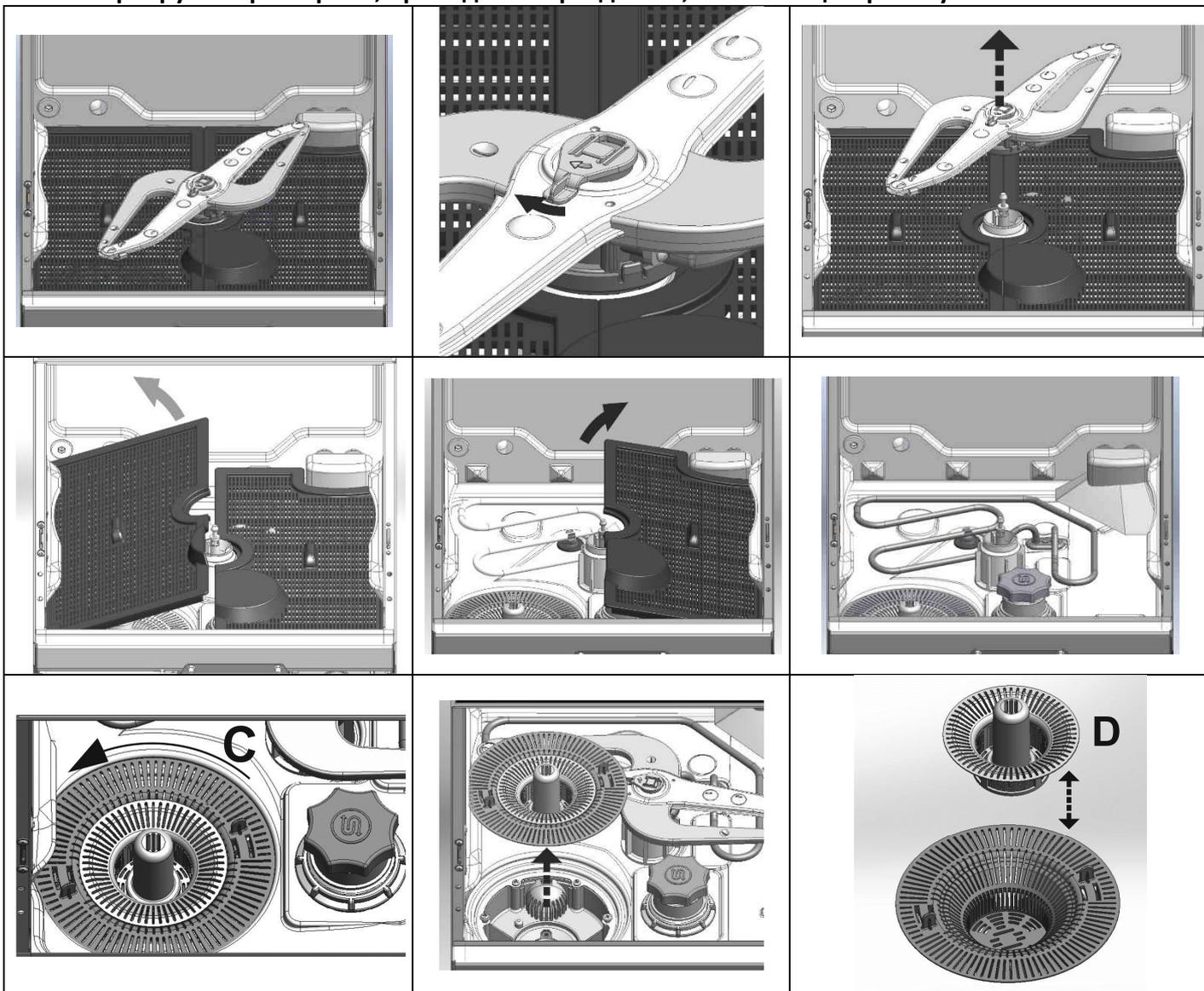
Процедура демонтирования фильтров с двумя фильтрующими элементами:
