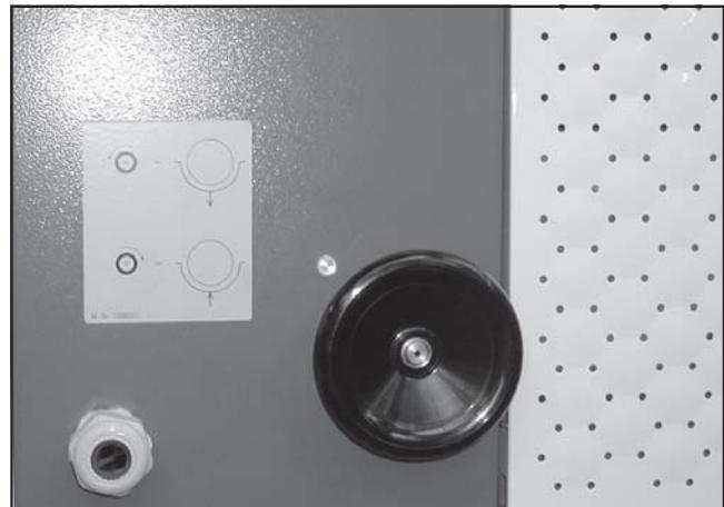
Для того, чтобы при нарушении электроснабжения можно было отделить горячую мульду от остановившегося гладильного вала: при вращении против часовой стрелки мульда опускается, при вращении по часовой стрелке мульда поднимается.
