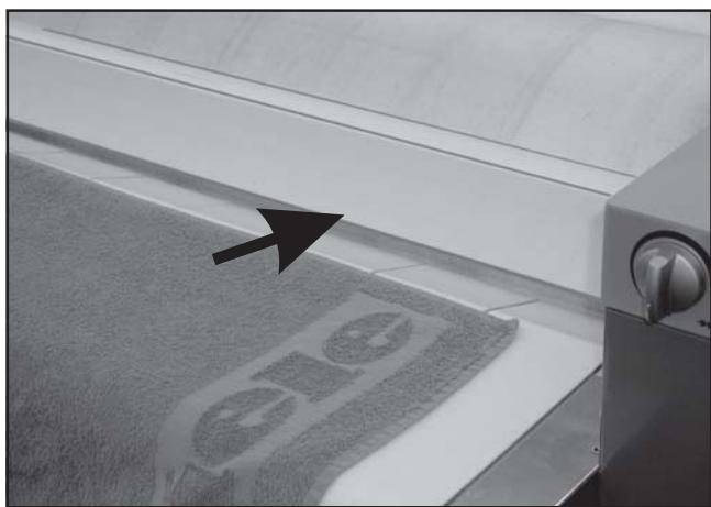
При попадании пальцев между столом подачи белья и планкой защиты пальцев гладильный вал сразу останавливается, а мульда опускается вниз. В режиме обратного хода планка защиты пальцев не функционирует.
