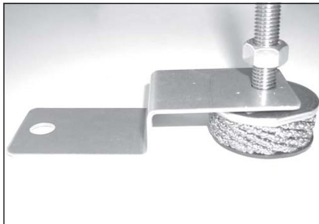
Снять контргайку с ножки, вставить фиксирующую пластину, завернуть контргайку и привернуть ножку к стойке машины.
