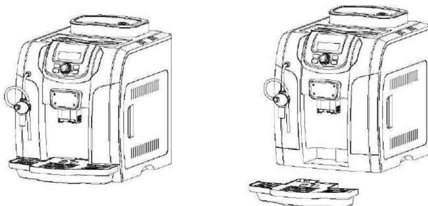
10. Проверьте красный поплавок, он не должен быть выше поверхности лотка для сбора воды. Достаньте лоток из машины и почистите. После чистки установите его на место.
