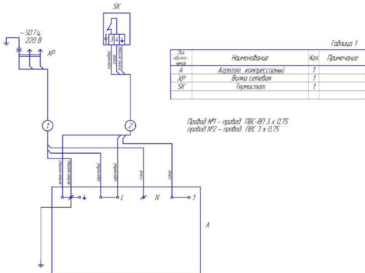
1. Схема электрическая для исполнения с термостатом без электродвигателя вентилятора.
