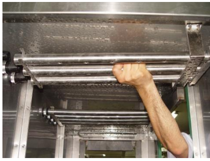
КОЛЛЕКТОР ПРЕДВАРИТЕЛЬНОЙ ПРОМЫВКИ НА ВХОДНОЙ СТОРОНЕ МАШИНЫ
