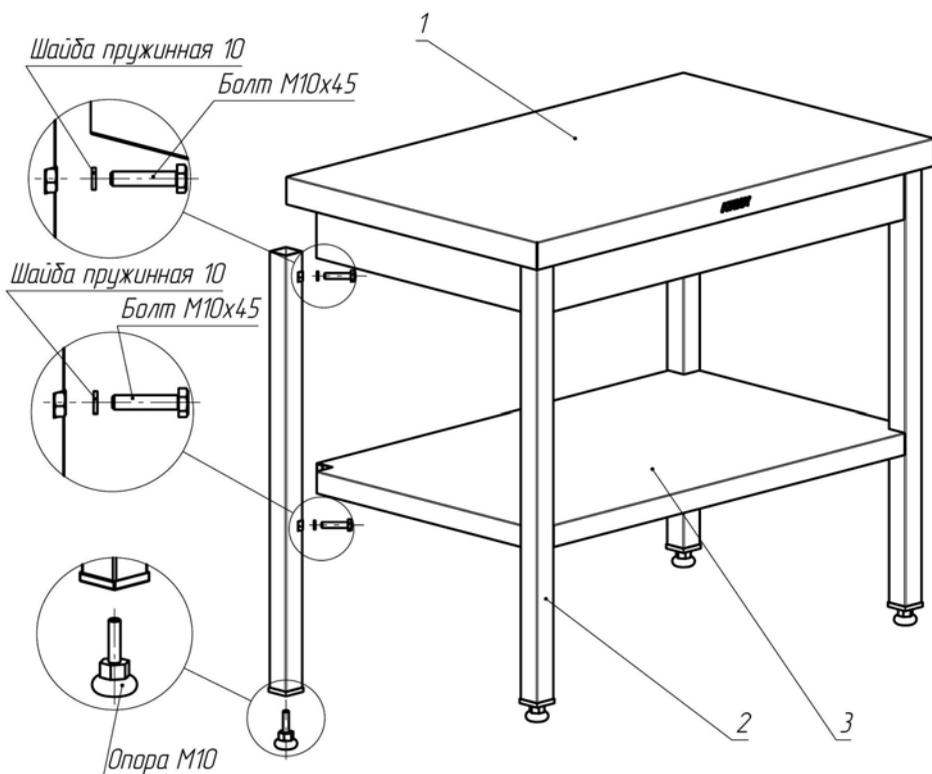
2.5. Произвести окончательную затяжку всех болтовых соединений.
