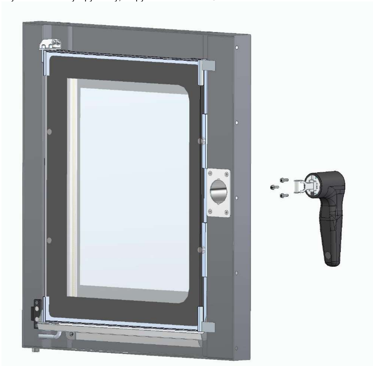
Рис.21 Ремонт замкового устройства
