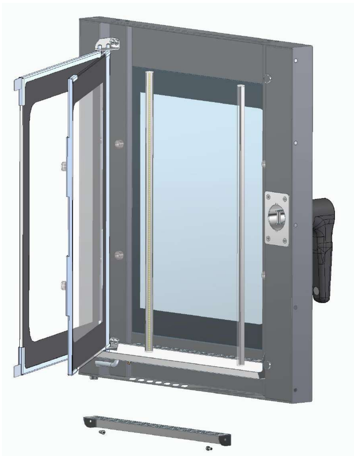
Рис. 23 Замена ламп освещения
