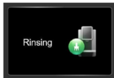
Прополоскать блок заваривания, используя эту опцию. Процесс полоскания завершается примерно через 30 секунд.
