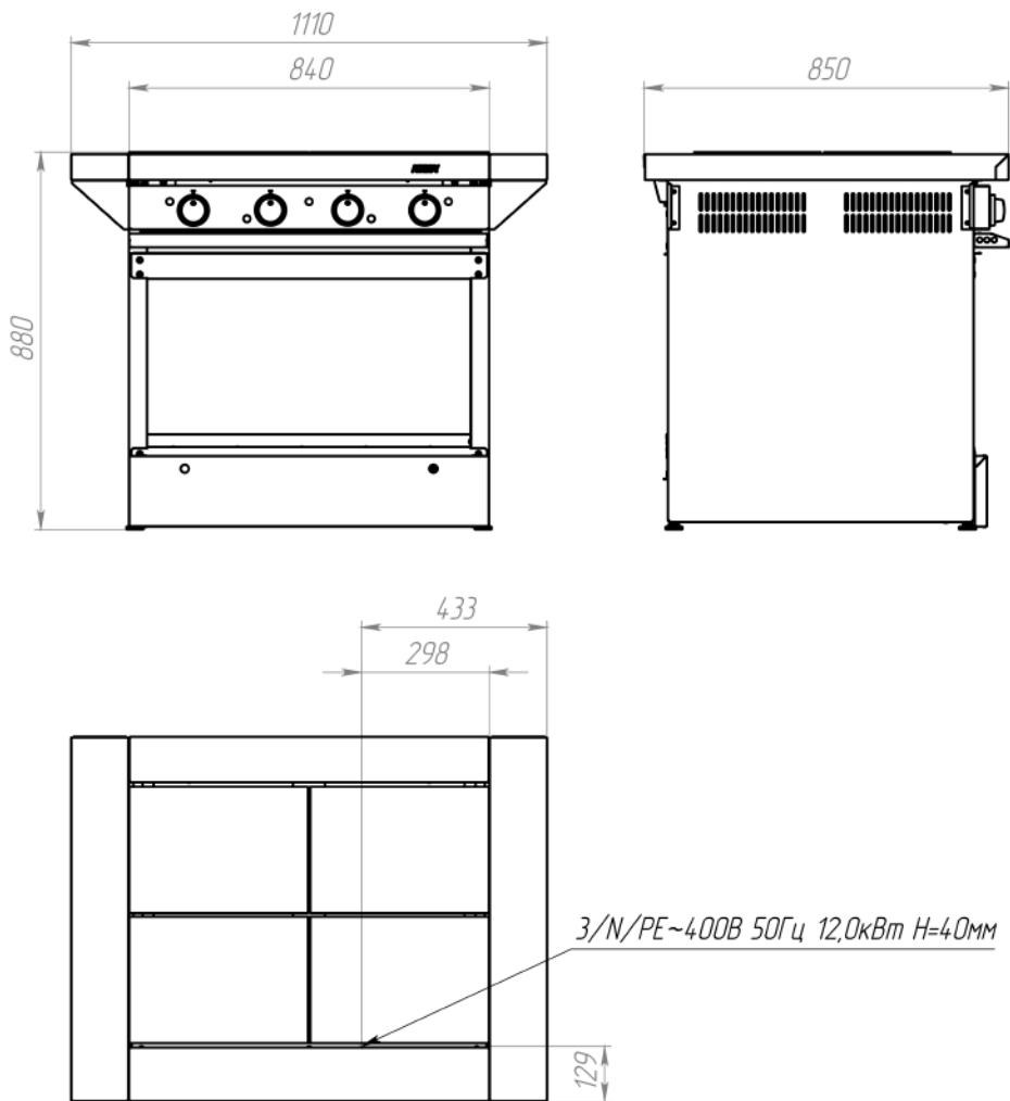
Рис.9 Габариты и схема подключений ЭПЧ-9-4-12-06.
