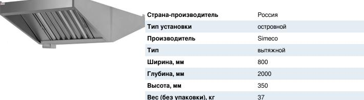
Зонт вытяжной центральный <u>Simeco 3BL0820</u> предназначен для очищения воздуха от излишков пара, дыма, жира и продуктов горения на предприятиях общественного питания и подключается к существующей системе вентиляции. Модель оснащена съемными лабиринтными жироулавливающими фильтрами. Корпус выполнен из нержавеющей стали AISI 430.
