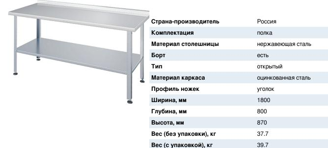
Производственный стол <u>ATESY CP-C-1-1800.800-02-ПСО</u>ц серии Стандарт предназначен для раскатки теста и обработки ингредиентов на предприятиях общественного питания и торговли. Полка и каркас выполнены из оцинкованной стали толщиной 1,2 мм, столешница - из нержавеющей стали AISI 430 толщиной 0,8 мм, ножки - из нержавеющей стали, опора ножек - из пластика.
