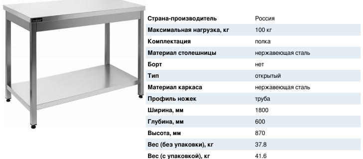
Столешница стола Кобор СП-150/60 произведена из высококачественной нержавеющей стали, а также для увеличения прочности и во избежание прогибания укреплена ламинированной древесно-стружечной плитой толщиной 16 мм. Ножки стола регулируются по высоте, что помогает избежать наклона рабочей поверхности стола. Каркас стола выполнен из профильной трубы 40х40 мм. Товар поставляется в разобранном виде и в упаковке для облегчения транспортировки.
