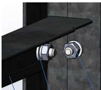
Шайбы Гайка Болт М6х14 Уголок продольный Уголок поперечный
